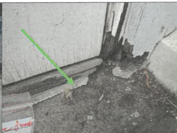
Figur 8-13 Prov 22 Vit fog vid entrédörr. Asbest ej påvisad.
