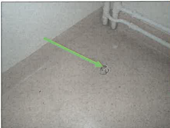
Figur 7-7 Prov 4. Svart lim under PVC matta. Asbest ej påvisad.
